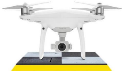
Сурет 1. ҰША (Propeller PPK, пилотсыз ұшақ DJI Phantom 4 RTK)
