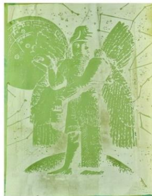
Рисунок 8. Рисунок на сетке после фотоэкспозиции.
