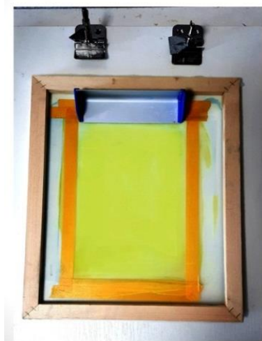
Рисунок 8. Рисунок на сетке после фотоэкспозиции.
