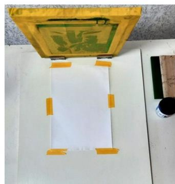
Рисунок 8. Рисунок на сетке после фотоэкспозиции.
