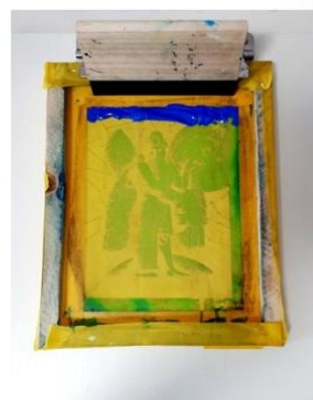
Рисунок 8. Рисунок на сетке после фотоэкспозиции.
