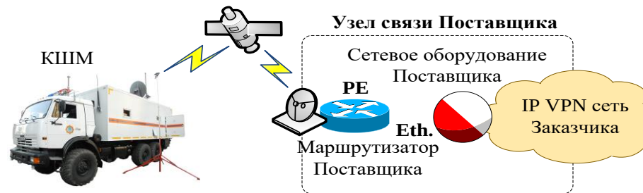
Схема 6. Организация подключения Конечных пользователей Услуг к СПД с использованием VSAT технологии для подвижных объектов.
